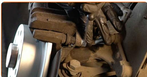
**18** Fjern bremsekaliberen.
