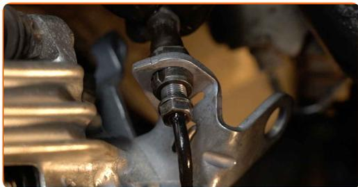
**27** Skru befæstigelsen ind der forbinder bremserøret til bremseslangen. Brug en kombinøgle N° 11.
