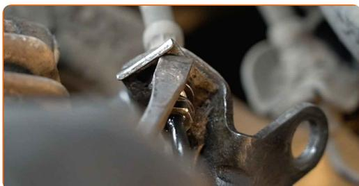
**16** Frigør bremserøret fra bremseslangen.
