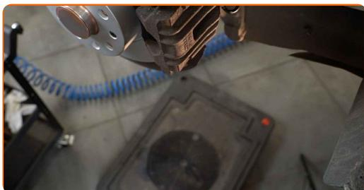
**13** Skru bremserøret af bremseslangen. Brug en kombinøgle N° 11.
