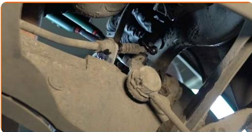
**9** Frigør parkeringsbremsekablet. Brug vandpumpe tænger.
