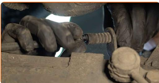
**10** Rengør området hvor bremseslangen er forbundet til bremsekalibren og bremsekredsløb rør. Brug en stålbørste. Brug WD-40 spray.
