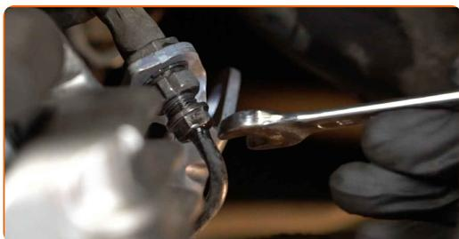
**28** Installer bremseslange holderklipsen. Brug en gummihammer.
