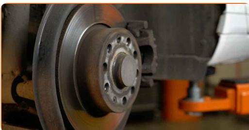
7 Rengør parkeringsbremsebeslag. Brug en stålbørste. Brug WD-40 spray.
