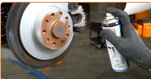
**40** Rengør bremsektivens overflade. Brug bremserens.
