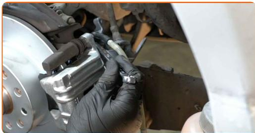
**32** Dræn bremsekaliber systemet. Tryk på bremsepedalen flere gange, indtil du kan mærke en betydelig modstand, uden at starte motoren.
