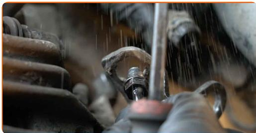
**17** Skru kaliberens skruer af. Brug en kombinøgle N° 13. Brug en kombinøgle N° 15.
