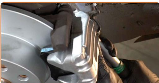
**39** Behandle overfladen hvor bremseeskiven har kontaktflade til hjulnavet. Brug kobberfedt.
