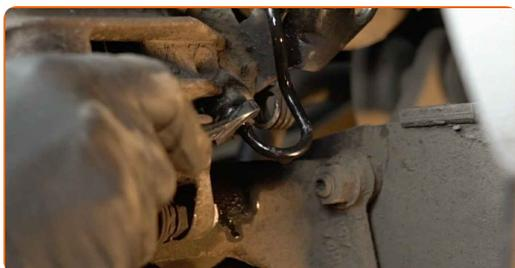
**15** Fjern bremseslang holderklipsen. Brug et koben.
