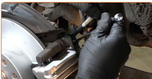
**34** Afbryd bremse udluftningssettet.
