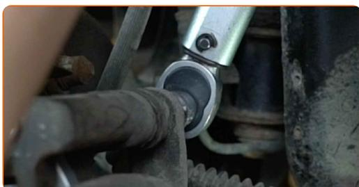
**36** Behandle overfladen hvor bremseeskiven har kontaktflade til hjulnavet. Brug keramisk fedt.
