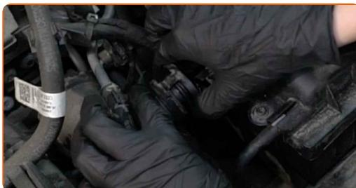
**4** Afbryd vakuumslangen fra luftfilterhuset.
