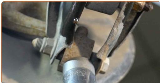
8 Skru de nedre skruer af støddæmperen. Brug en kombinøgle № 18. Brug en topnøgle №18. Brug en skraldenøgle.
