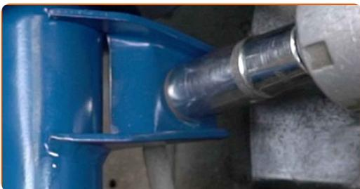
**55** Støt styrekuglen. Brug en hydraulisk løfteenhed.
