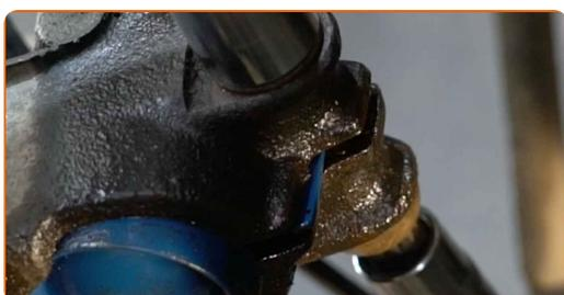
**51** Installer og spænd boltene på kardanaxsel. Brug 12-kantet topnøgle nr. 24. Brug en skraldenøgle.
