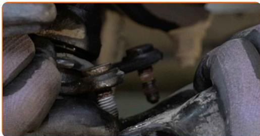
23 Støt styrekuglen. Brug en hydraulisk løfteenhed.
