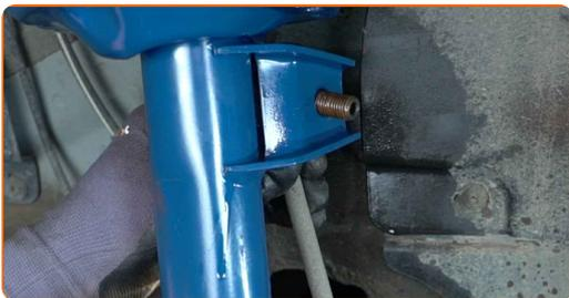
**54** Skru fastgørelsesen, der forbinder krængningsstabilisatoren med fjederbenet, i. Brug en kombinøgle № 18. Brug XZN #6. Brug en skraldenøgle.
