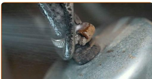
**9** Løsen klammerne på brændststoffilter rørene. Brug en skruetrækker med lige kærv.
