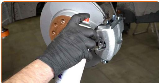
Udskiftning: bremsekaliber – SEAT Mii (KF1\_). Råd fra AUTODOC eksperter:
