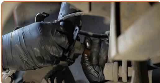
**29** Frigør den nedre befæstigelse der forbinder fjederbenet til stubakslen. Brug særlige skiftenøgler for at fjerne støddæmperen. Brug en skraldenøgle.
