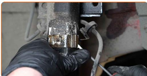
**18** Afbryd bremseslangen. Brug et koben.
