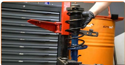
**44** Behandel montagestedet til fjederbenet. Brug en stålbørste. Brug WD-40 spray.
