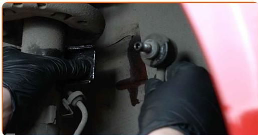
**16** Rengør ABS ledningsnettets beslag. Brug en stålbørste. Brug WD-40 spray.
