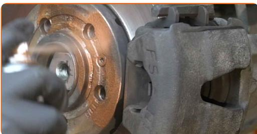
**69** Rengør bremseskivens overflade. Brug bremsrens.
