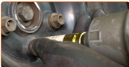
**47** Sænk bilen og stram hjulboltene på kryds med. Brug hjul slagnøgle #19. Brug en momentnøgle. Stram den til 170 Nm moment.
