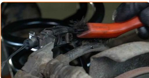
**8** Træk stikket ud til bremseklods slidsensoren.
