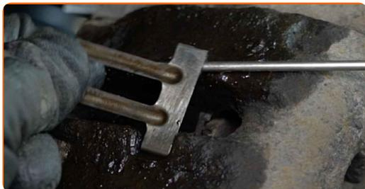
**11** Rengør bremsekaliberens fastgørelser. Brug en stålborste. Brug bremserens.
