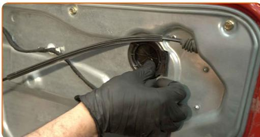
**51** Fastgør sidespejl justeringsforbindelse til betjeningskontakten.
