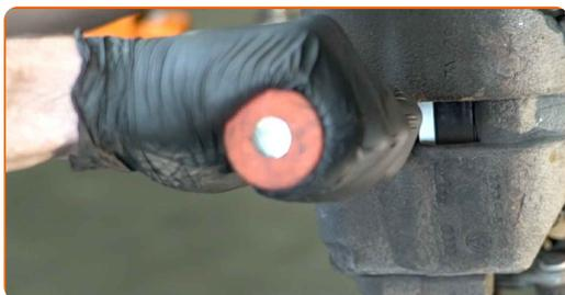
**14** Fjern låsefjederen på bremseklodserne. Brug et koben.
