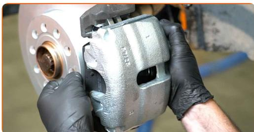
**19** Monter støvhætter på bremsekaliberens styretapper.
