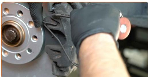
**15** Fjern bremsekaliberen.
