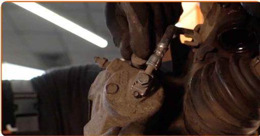
21 Rengør bremsektivens overflade. Brug en stålbørste. Behandle overfladen hvor bremsestiven har kontaktflade til hjulnavet. Brug kobberfedt.
