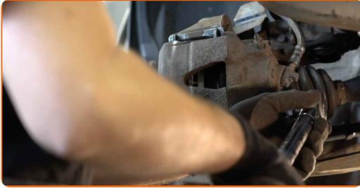
20 Monter støvhætter på bremsekaliberens styretapper.
