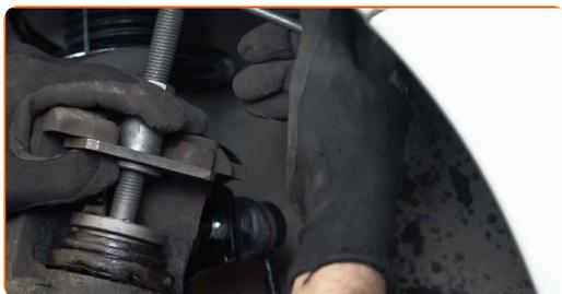
**16** Rens bremsekaliberens beslag for skidt og støv. Brug en stålbørste.
