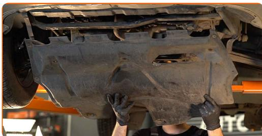
16 Skru fastgørelsen af på den nedre lydisolering ind. Brug en topnøgle N°12. Brug en Phillips skruetrækker.
