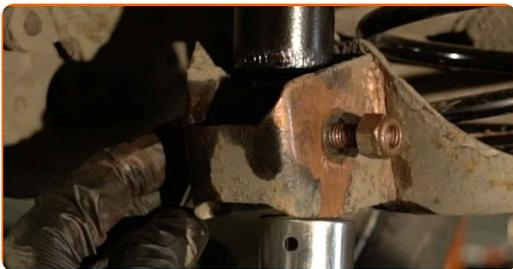
**20** Stram den nedre fastgørelse på støddæmperen. Brug en kombinøgle N° 16. Brug en topnøgle N°16. Brug en momentnøgle. Stram den til 40 Nm moment.+90°
