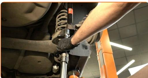
**8** Skru de nedre skruer af støddæmperen. Brug en kombinøgle N° 16. Brug en topnøgle N°16. Brug en skraldenøgle.
