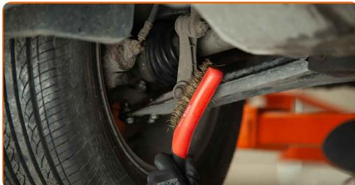
3 Løsne befæstigelserne der forbinder krængningsstabilisatoren og til ophænget på bæremælene. Brug en kombinøgle № 16. Brug en momentnøgle.
