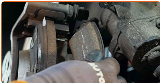
**17** Rengør bremsekaliberen befæstigelse. Brug en stålborste. Brug WD-40 spray.
