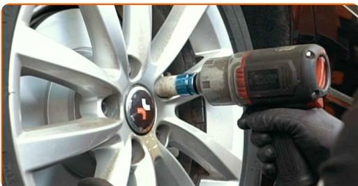
**38** Sænk bilen og stram hjulboltene på kryds med. Brug hjul slagnøgle #17. Brug en momentnøgle. Stram den til 120 Nm moment.
