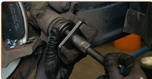
**33** Monter bremsekaliberen og sæt den fast. Brug en kombinøgle № 15. Brug en topnøgle №13. Brug en momentnøgle. Stram den til 35 Nm moment.
