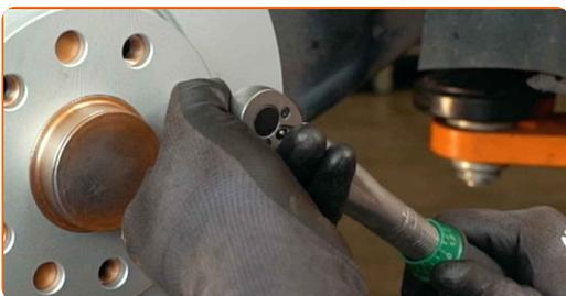
**27** Rens bremsekaliberens beslag for skidt og støv. Brug en stålbørste. Brug bremserens.
