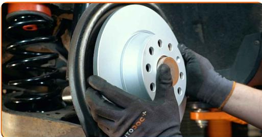
**26** Stram bremseskivens skruer. Brug Torx T30. Brug en momentnøgle. Stram den til 4 Nm moment.
