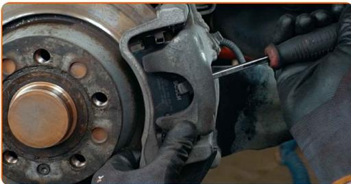
**13** Rengør bremsekaliberens fastgørelser. Brug en stålbørste. Brug WD-40 spray.
