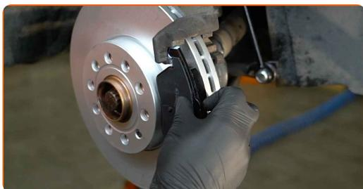
**28** Monter bremsekaliberen og sæt den fast. Brug HEX nr. H7. Brug en momentnøgle. Stram den til 30 Nm moment.
