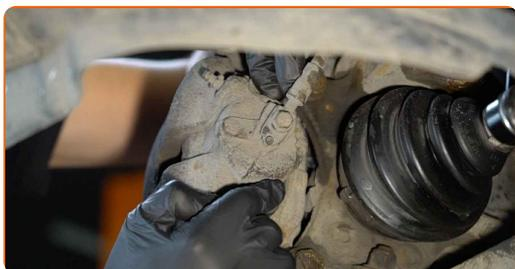
**30** Monter bremsekaliberens holdefjeder.
