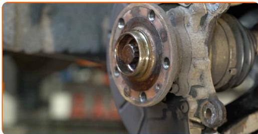
**19** Rengør navet. Brug en stålbørste. Behandl kontaktfladen. Brug kobberfedt.
