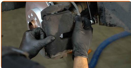
**29** Monter støvhætter på bremsekaliberens styretapper.
