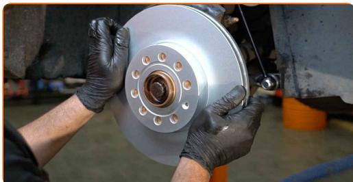
**21** Stram bremseskivens skruer. Brug Torx T30. Brug en momentnøgle. Stram den til 4 Nm moment.
