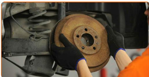
9 Rengør navet. Brug en stålbørste. Behandl kontaktfladen. Brug kobberfedt.
