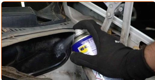
**5** Løsen befæstigelse til forrude viskerblade torpedopladen. Brug en topnøgle N°10. Brug en skraldenøgle.
