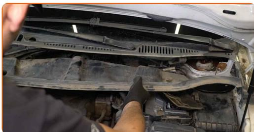
**78** Skru befæstelserne ind til forrude visker torpedoplade. Brug en topnøgle N°10. Brug en momentnøgle. Stram den til 4 Nm moment.
