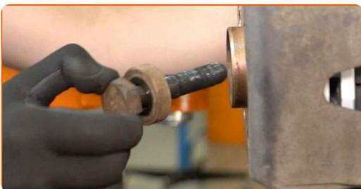
**24** Rengør befæstigelses forbindelsen fra styrekuglen til ophængets bærearm. Brug en stålbørste. Brug WD-40 spray.
