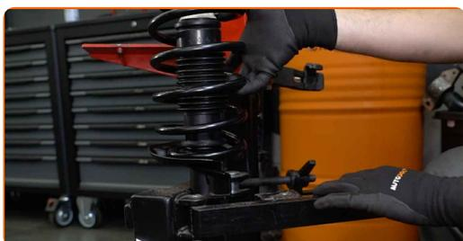
**46** Behandle fjederbenets befæstigelse på stubakslen. Brug en stålbørste. Brug WD-40 spray.
