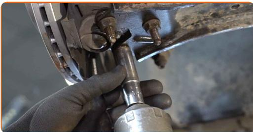
**58** Installer og spænd boltene på kardanaxsel. Brug en topnøgle N°27. Brug en skraldenøgle.
