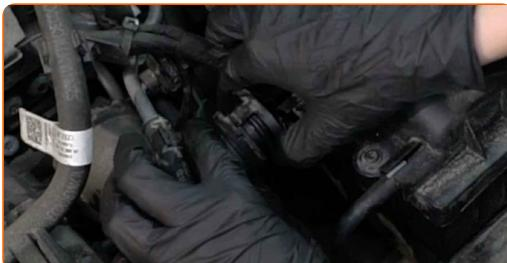
**4** Afbryd vakuumslangen fra luftfilterhuset.
