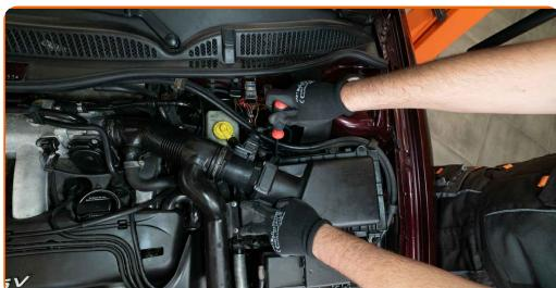
**4** Træk stikket til luftstrømsføleren ud af kontakten. Løsn klemmen og fjern slangene til luftindsugningen fra filterhuset. Brug kombinationstænger.
