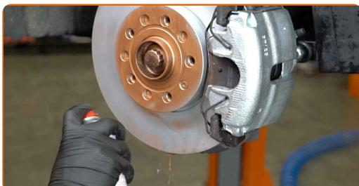
Udskiftning: bremseklodser – SKODA Rapid Hatchback (NH3). Råd fra AUTODOC eksperter:
