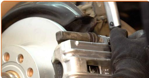
**21** Behandel bremserørene. Brug bremserens.
