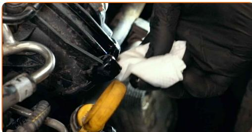
**55** Installer gasspjæld på indsugningsmanifold. Installer fastgørelseseboltene.
