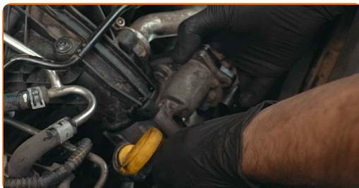
**56** Spænd gasspjældets fastgørelse fast til luftindtagets manifold. Brug Torx T27. Brug en momentnøgle. Stram den til 14 Nm moment.
