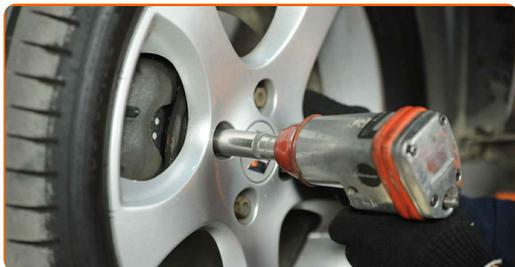
**22** Sænk bilen og stram hjulboltene på kryds med. Brug hjul slagnøgle #21. Brug en momentnøgle. Stram den til 85 Nm moment.
