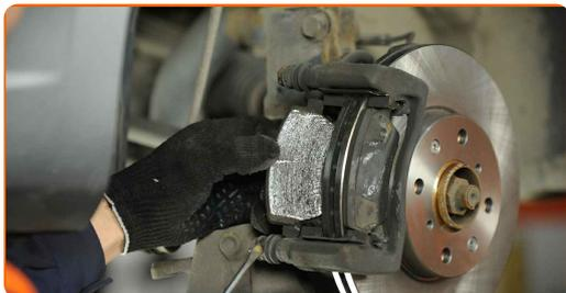
Udskiftning: bremseklodser – SUZUKI SPLASH. AUTODOC eksperter anbefaler:
