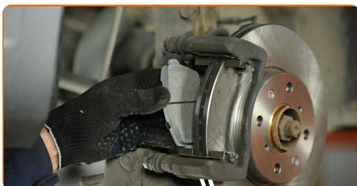
**Udskiftning: bremseklodser – SUZUKI SPLASH. AUTODOC anbefaler:**
