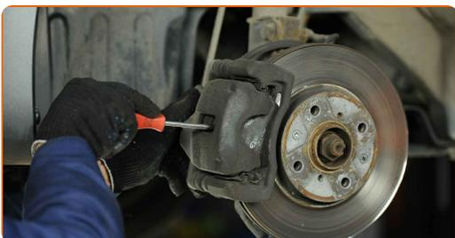
**10** Fjern bremsekaliberen.
