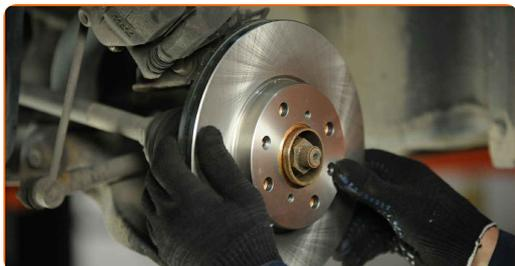
**21** Stram bremseskivens skruer. Brug Torx T30. Brug en momentnøgle. Stram den til 9 Nm moment.
