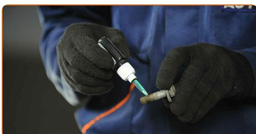
**29** Installer bremsekaliberens beslag.
