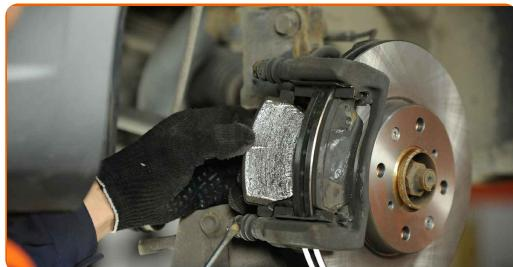
**Udskiftning: bremseklodser – Suzuki Swift MK3. AUTODOC eksperter
