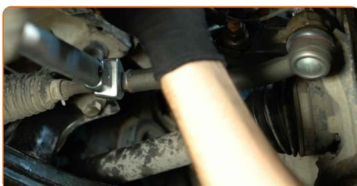
**21** Behandel befæstigelsen der forbinder forbindelsesstangen og styrespindlen. Brug kobberfedt.
