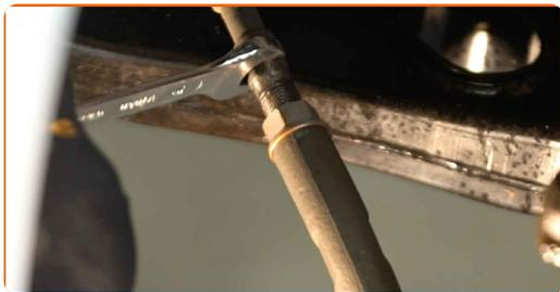
**16** Når du afmonterer, skal du markere eller måle den eksakte position for kugleledet på springsstangen, eller tælle antallet af omgange du drejer, for at forhindre en efterfølgende dårlig spring. Brug en skydelære.
