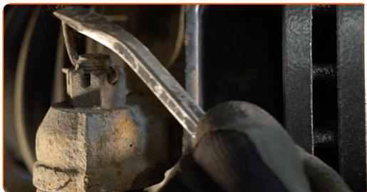
**7** Rengør befæstigelsen der forbinder forbindelsesstangen og styrespindel. Brug en stålborste. Brug WD-40 spray.
