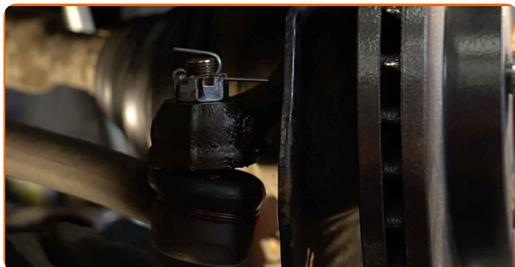
**20** Stram endens låsemøtrik med. Brug en kombinøgle N° 15. Brug en kombinøgle N° 19. Brug en momentnøgle. Stram den til 74 Nm moment.
