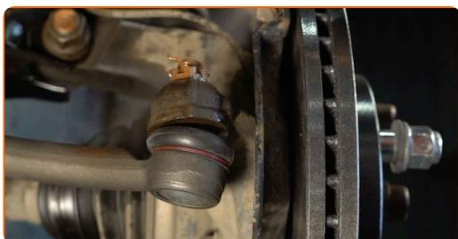
**22** Behandle overfladen hvor bremseskiven har kontaktflade til hjulnavet. Brug kobberfedt.
