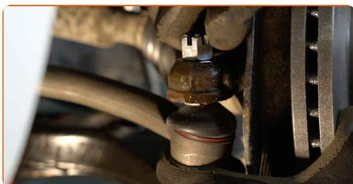
**18** Stram møtrikken der forbinder forbindelsesstangen og styrespindlen. Brug en topnøgle №19. Brug en momentnøgle. Stram den til 49 Nm moment.
