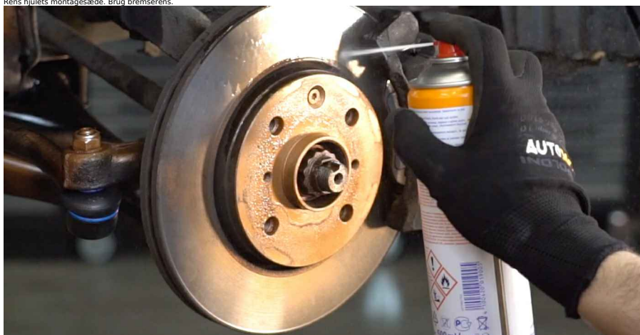
23 Rens hjulets montagesæde. Brug bremserens.
