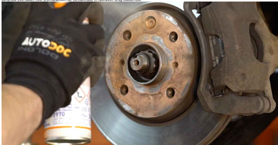
23 Rens hjulets montagesæde. Brug bremserens.
