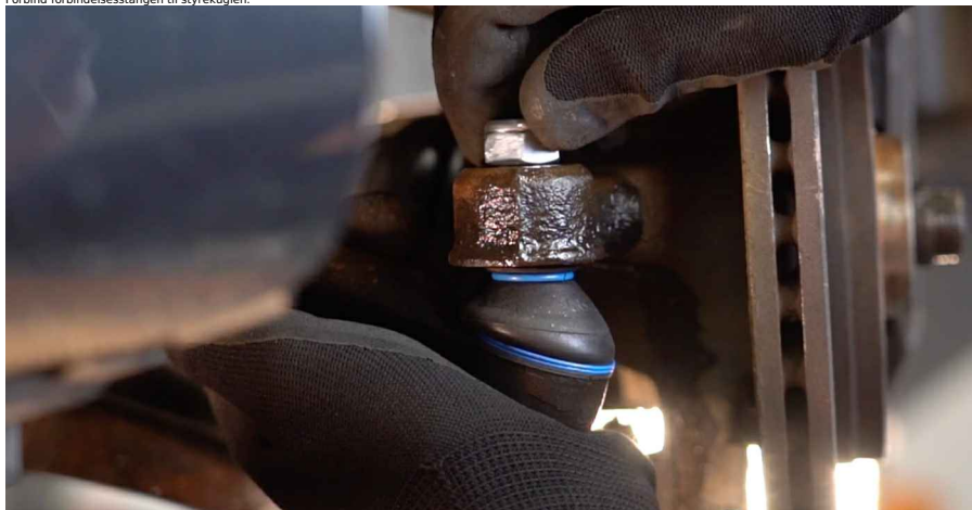
18 Stram møtrikken der forbinder forbindelsesstangen og styrespindlen. Brug en topnøgle N°17. Brug en momentnøgle. Stram den til 33 Nm moment.
