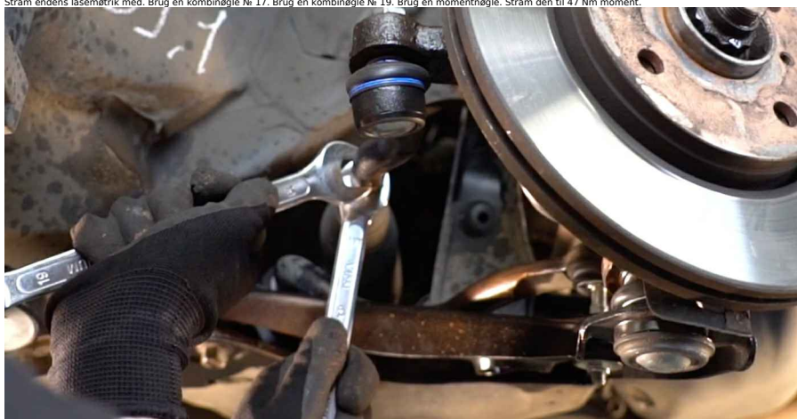
20 Monter splitten, der holder forbindelsesstangens enders beslag. club.autodoc.dk 7-11
