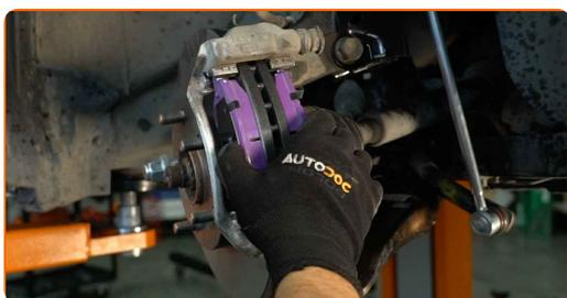
**23** Behandel bremsekaliber cylinder. Brug bremserens.
