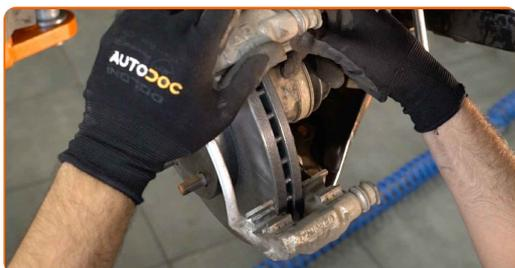
**21** Stram bremsekaliberens beslag. Brug en topnøgle №17. Brug en momentnøgle. Stram den til 107 Nm moment.
