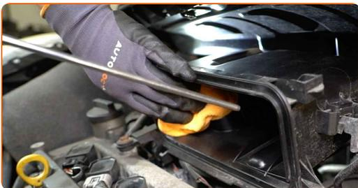
**8** Fjern mikrofiber håndklædet fra luftindsugningsslangen.
