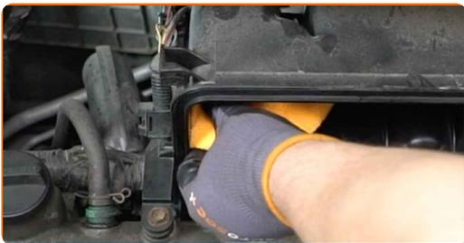
**6** Fjern filterelementet fra luftfilterets cover.
