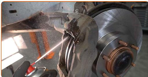
Udskiftning: bremseklodser – TOYOTA HILUX III pick-up (TGN1\_, GGN2\_, GGN1\_, KUN2\_, KUN1\_). Råd:
