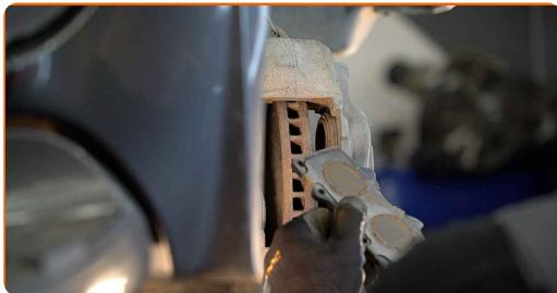
Udskiftning: bremseklodser – TOYOTA LAND CRUISER 150 (KDJ15\_, GRJ15\_).
