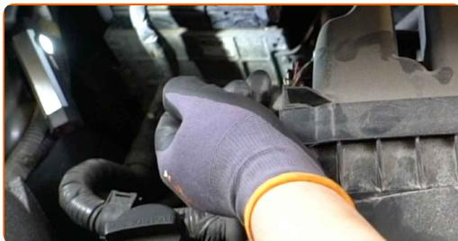
**4** Afbryd luftindsugningsrør fra luftfilterhuset.
