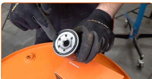
**16** Skru det nye filterhus på. Brug 76-14F spændenøgle. Brug en momentnøgle. Stram den til 17 Nm moment.
