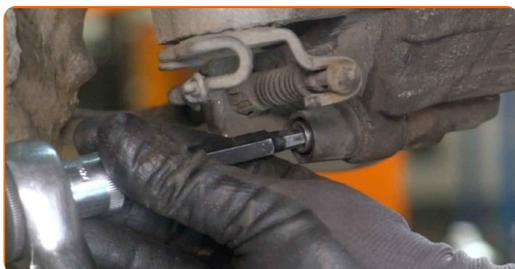
**30** Monter støvhætter på bremsekaliberens styretapper.
