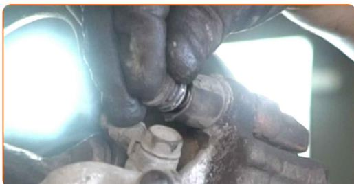
**31** Monter bremsekaliberens holdefjeder.
