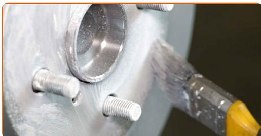
**33** Rengør bremseskivens overflade. Brug bremsrens.
