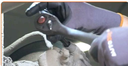
**10** Fjern bremsekaliberen. Brug et koben.
