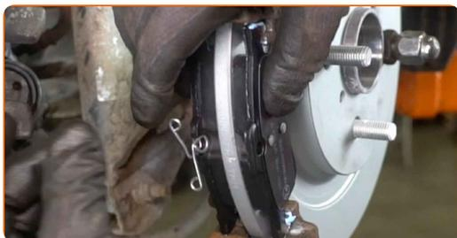
**28** Monter bremsekaliberen og sæt den fast.
