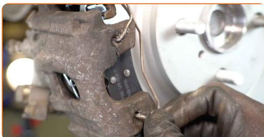
**32** Behandle overfladen hvor bremseeskiven har kontaktflade til hjulnavet. Brug keramisk fedt.
