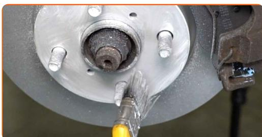
**34** Rengør bremseskivens overflade. Brug bremsrens.
