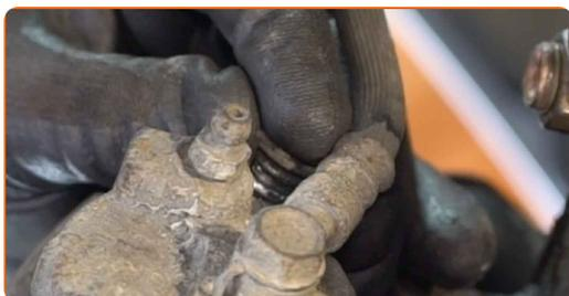
**32** Monter bremsekaliberens holdefjeder. Brug et koben.
