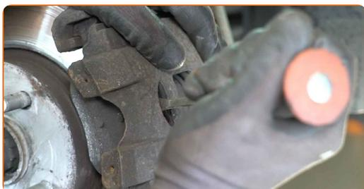
**11** Fjern bremsekaliberen. Brug et koben.
