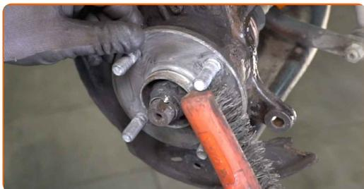
**19** Behandel kontaktfladen. Brug keramisk fedt.
