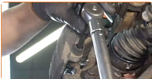
**31** Monter støvhætter på bremsekaliberens styretapper.
