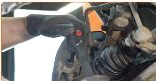
**9** Løsgør bremsekaliber låsefjeder. Brug et koben.
