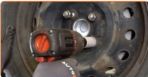
**50** Sænk bilen og stram hjulboltene på kryds med. Brug hjul slagnøgle #21. Brug en momentnøgle. Stram den til 103 Nm moment.
