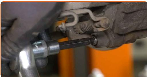
**43** Monter støvhætter på bremsekaliberens styretapper.
