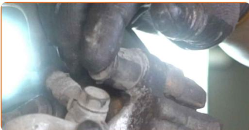
**44** Monter bremsekaliberens holdefjeder.
