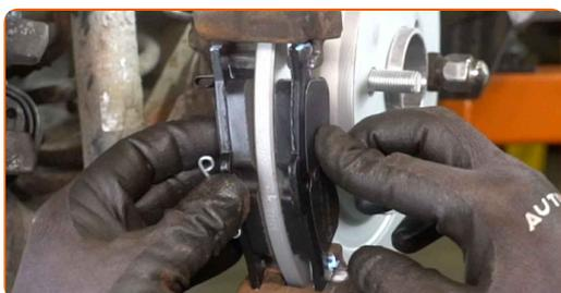
**41** Monter bremsekaliberen og sæt den fast.
