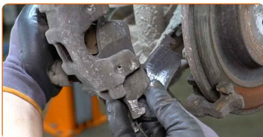
**12** Rengør bremsekaliberen befæstigelse. Brug en stålbørste. Brug WD-40 spray.
