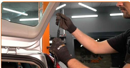
**Udskiftning: bagklapsdæmper – Volvo V50 MW. AUTODOC eksperter
