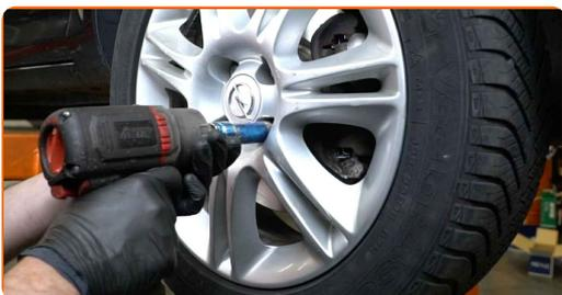
**35** Sænk bilen og stram hjulboltene på kryds med. Brug hjul slagnøgle #17. Brug en momentnøgle. Stram den til 110 Nm moment.
