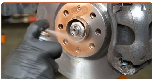
**32** Rengør bremseklodsens overflade. Brug bremserens.
