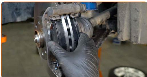
**30** Monter bremsekaliberen og sæt den fast. Brug en topnøgle N°13. Brug en momentnøgle. Stram den til 30 Nm moment.
