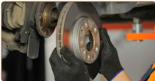
**21** Rengør navet. Brug en stålbørste. Behandl kontaktfladen. Brug kobberfedt.
