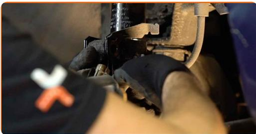
**33** Stram den nedre befæstigelses forbindelse mellem fjederben og styrespindel. Brug en kombinøgle N°18. Brug en topnøgle N°18. Brug en momentnøgle. Stram den til 90 Nm moment.+45°
