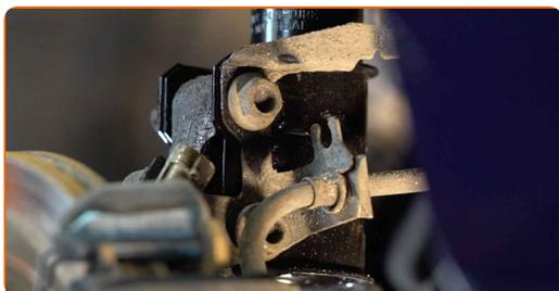
**37** Fastgør stabilisatorforbindelsen på stiveren. Brug en kombinøgle N°19. Brug en topnøgle N°18. Brug en momentnøgle. Stram den til 65 Nm moment.
