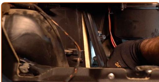
8 Fjern filterelementet fra filterhuset.
