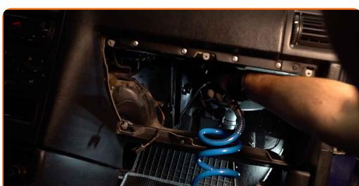
Udskiftning: luftfilter – VAUXHALL Astra Mk V (H) (A04) Hatchback. Råd fra AUTODOC eksperter:
