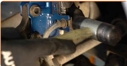
**51** Stram den nedre befæstigelses forbindelse mellem fjederben og styrespindel. Brug en kombinøgle N°18. Brug en topnøgle N°18. Brug en momentnøgle. Stram den til 105 Nm moment.
