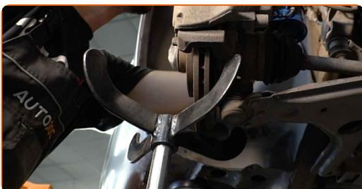
**48** Installer låsemøtrik på fjederbenets øvre beslag. Brug vandpumpe tænger.
