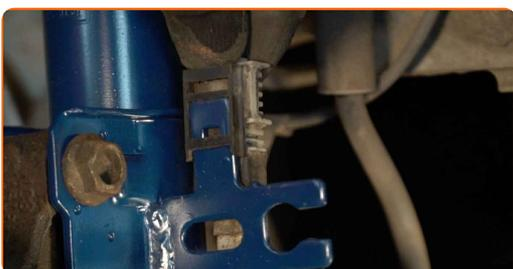
**50** Fastgør bremseslangen til stiveren. Brug en gummihammer.
