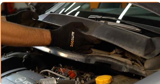
**5** Fjern fjederbenets montagedæksel. Brug en skruetrækker med lige kærv.
