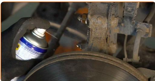
**17** Løsen den nedre befæstigelse der forbinder fjederbenet til stubakslen. Brug en kombinøgle N° 18. Brug en topnøgle N°18. Brug en vridenøgle.
