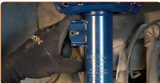
**53** Spænd befæstigelsen til der forbinder forbindelsesstangen med fjederbenet. Brug en topnøgle N°19. Brug en kombinøgle N°19. Brug en momentnøgle. Stram den til 55 Nm moment.
