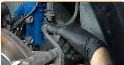
**55** Installer bremseslange holderklipsen. Brug en gummihammer.
