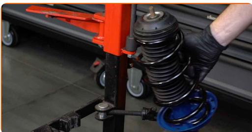
**46** Behandel montagestedet til fjederbenet. Brug en stålbørste. Brug WD-40 spray.
