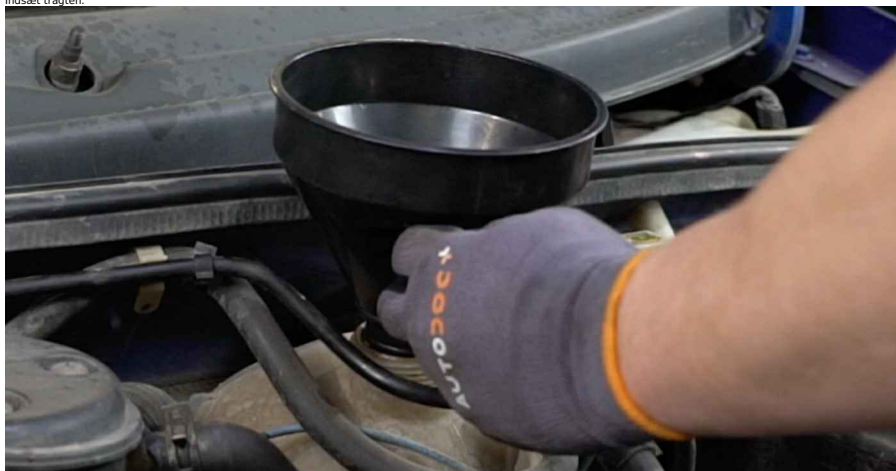
35 Hæld kølervæske på ekspansionsbeholderen.
