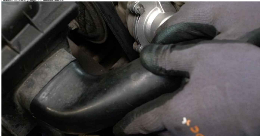
32 Tilslut clipsen på luftindtagsslangen.
