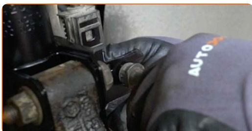
**48** Installer bremseslangen hæfteklampen. Brug en hammer.
