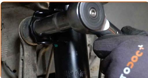
**51** Behandl befæstigelsen på fjederben belslaget. Behandl styrespindlens befæstigelser. Brug kobberfedt.
