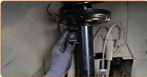
**50** Spænd befæstigelsen til der forbinder forbindelsesstangen med fjederbenet. Brug en kombinøgle № 17. Brug en topnøgle №18. Brug en momentnøgle. Stram den til 55 Nm moment.
