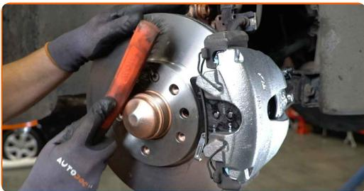
**53** Behandle overfladen hvor bremseskiven har kontaktflade til hjulnavet. Brug kobberfedt.
