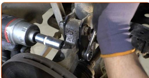
**17** Støt styrekuglen. Brug en hydraulisk løfteenhed.
