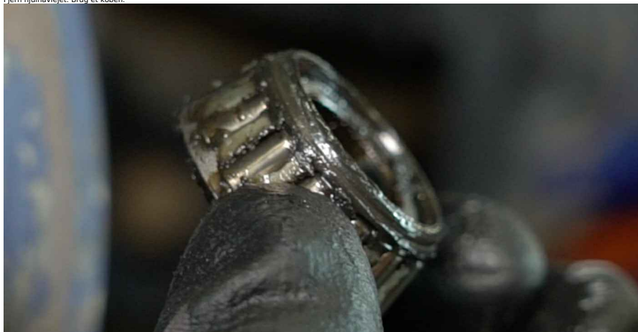
11 Fjern bremsetromle samling med hjulnavlejet.
