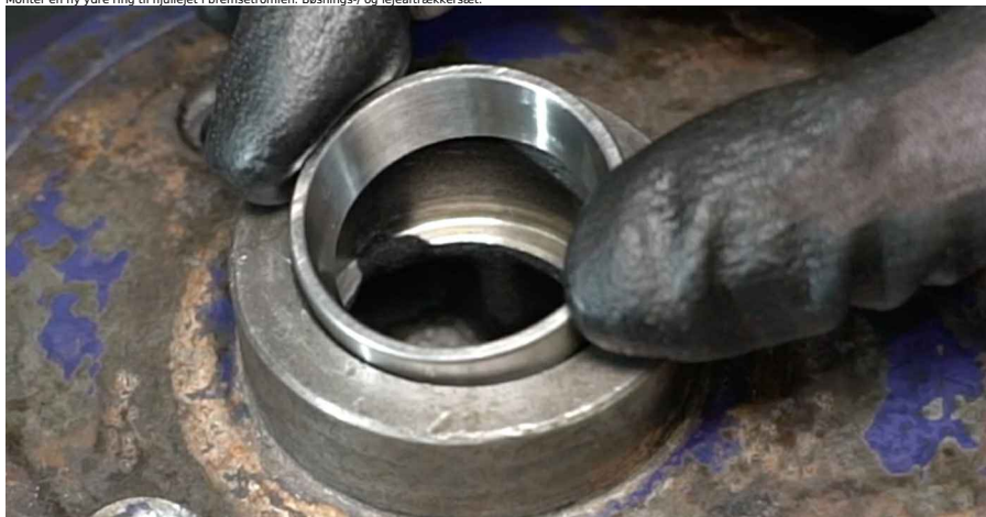
19 Installer den nye indre skal til hjullejet på bremsetromlen. Bøsnings- og lejeaftrækkesæt.
