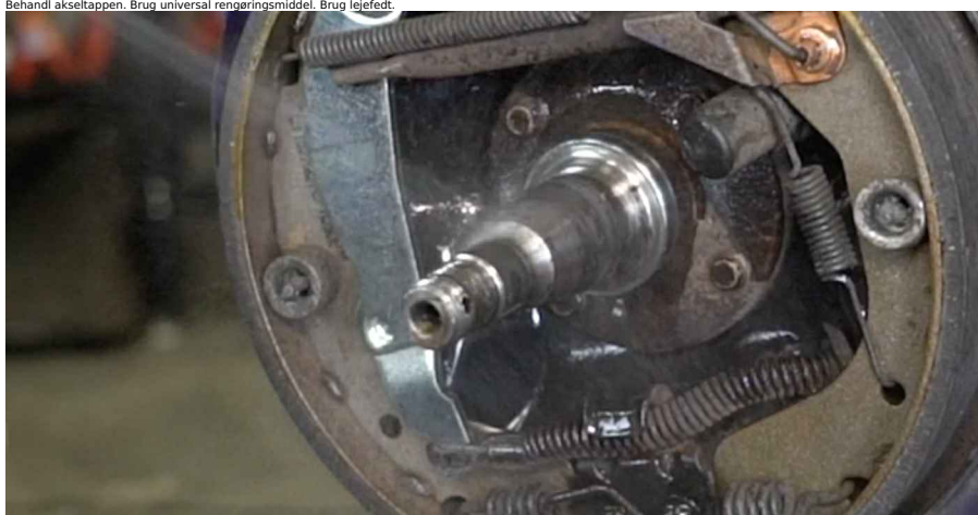
24 Installer bremsetromlens samling med hjulnavlejet.
