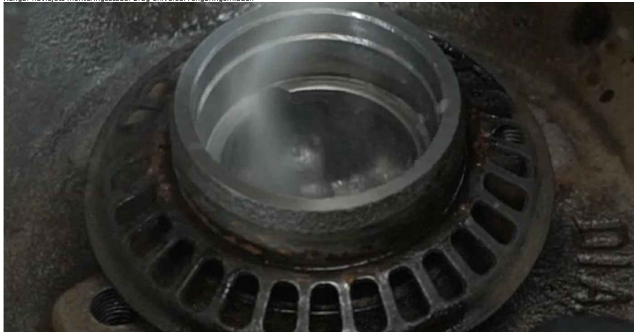
18 Montér en ny ydre ring til hjullejet i bremsetromlen. Bøsnings- og lejeaftrækkesæt.
