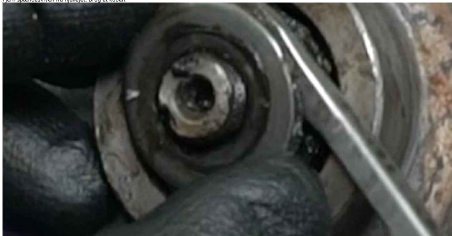
10 Fjern hjulnavlejet. Brug et koben.
