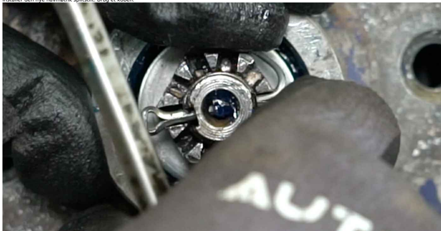
34 Monter dækslet til navets møtrik. Brug en gummihammer.
