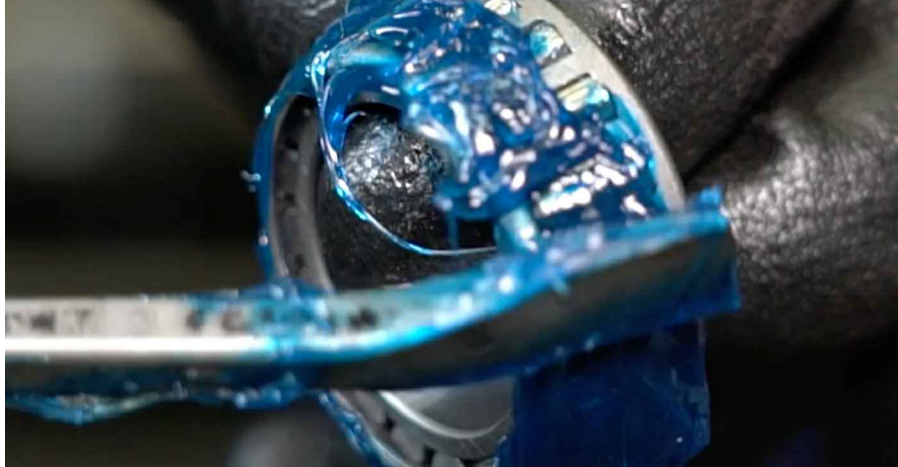
21 Installer et nyt navleje og fastgør det.
